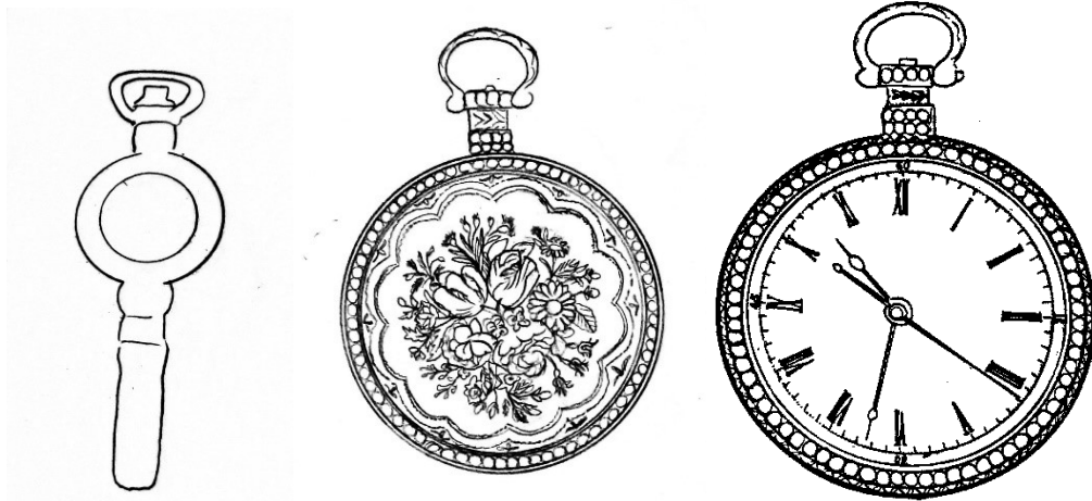
(شكل 3): وجه وظهر ومفتاح تعبئة وضبط ساعة الجيب نقلا عن لوحة 3 © عمل الباحثة
